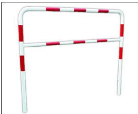
Rys. nr 5 poręcz zabezpieczająca z rur stalowych \varnothing 60 mm, malowanych proszkowo na biało i oklejonych folią czerwoną w pasy biało-czerwone. Szerokość paska czerwonego 15cm, o rozstawie słupków co 2m, H=110 cm
