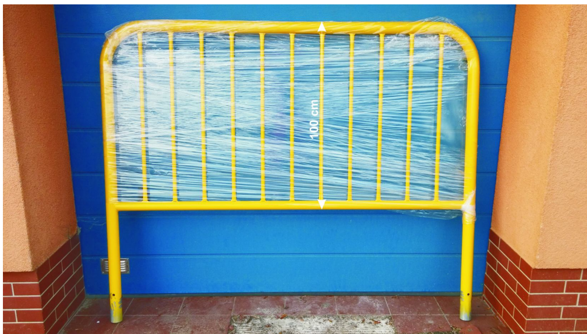
Rys. nr 4. Przykład poręczy zabezpieczającej z rur stalowych \phi 60mm z pionowymi słupkami \phi 20mm malowane proszkowo na kolor żółty. dł. 2m, wys. 110cm
