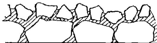
Rys. 3. Schematyczny obraz powierzchniowego utrwalenia nawierzchni typu „sandwich”
