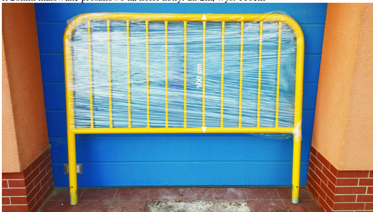
Rys. nr 5. Przykład poręczy zabezpieczającej z rur stalowych \phi 60\text{mm} z pionowymi słupkami \phi 20\text{mm} malowane proszkowo na kolor żółty. dł. 2m, wys. 110cm
