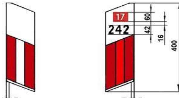
Rys. 2. Słupek prowadzący U-1b z naniesionym znakiem kilometrowym i hektometrowym, przeznaczony do umieszczenia na barierze ochronnej, w hektometrze zerowym
