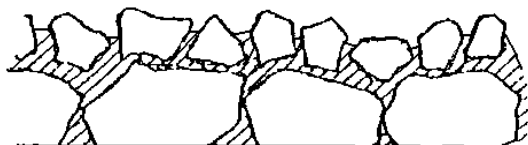
Rys. 3. Schematyczny obraz powierzchniowego utwalenia nawierzchni typu „sandwich”
