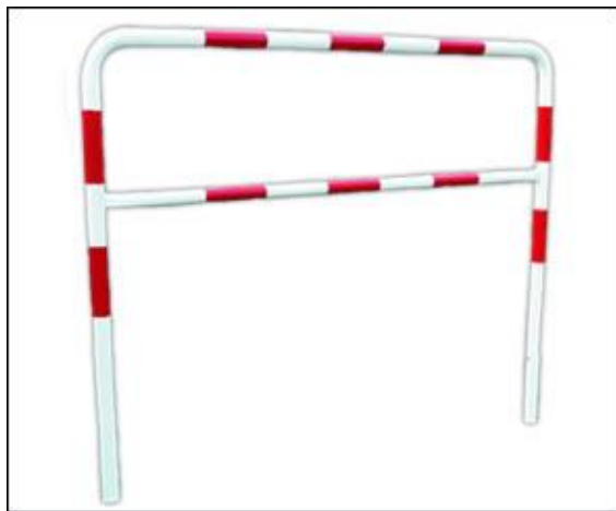
Rys. nr 5 poręcz zabezpieczająca z rur stalowych \phi 60 mm, malowanych proszkowo na biało i oklejonych folią czerwoną w pasy biało-czerwone. Szerokość paska czerwonego 15cm, o rozstawie słupków co 2m, H=110 cm
