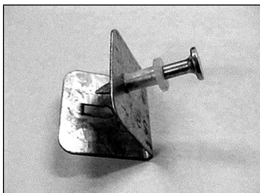
Rys. 5. Klips i kołek do mocowania siatki w podłożu. Klips zakłada się na poprzeczny pręt płaski siatki
